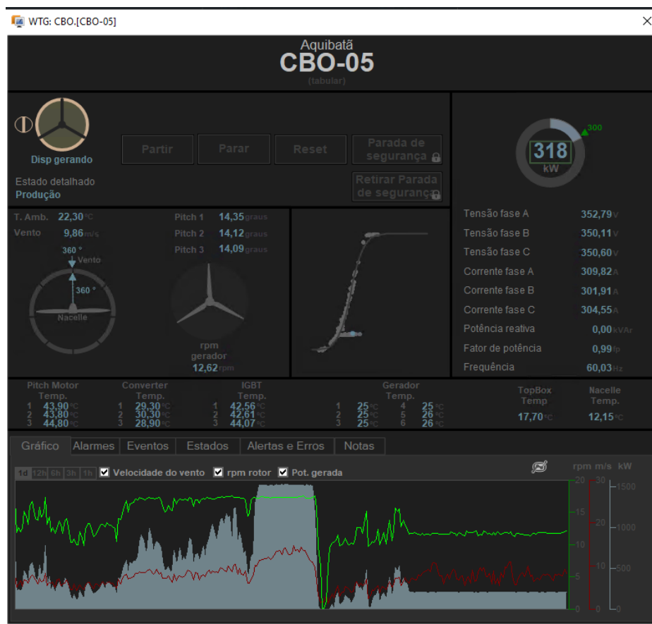
Controle de um aerogerador, com comandos de partida e parada, medidas analógicas e digitais, curva de potência e os gráficos das suas últimas 24 horas de funcionamento
