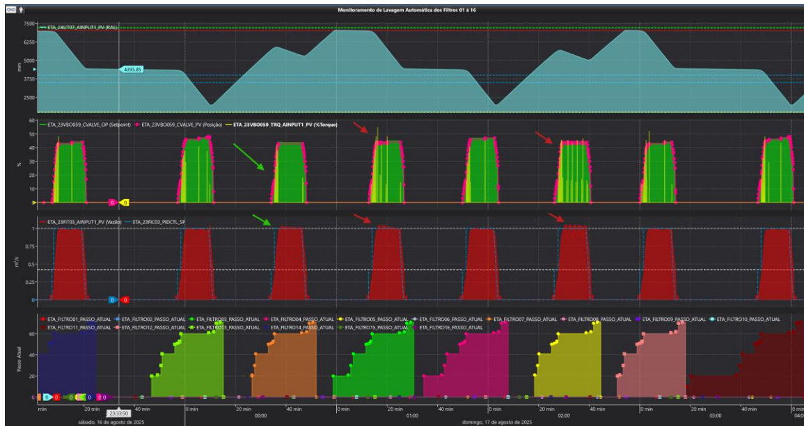
Ciclo de controle com leitura de torque normal (seta verde) e dois ciclos com leitura fora do padrão (seta vermelha), ocasionando oscilações no controle de vazão na ETA
