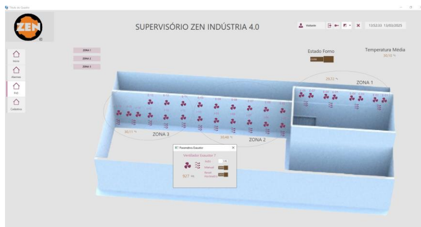
Tela do Eclipse E3 para controle do forno e exaustores do pavilhão na fábrica da ZEN
