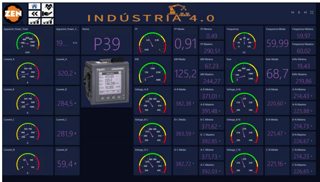
Controle das variáveis mensuradas junto a um multimetro de energia
