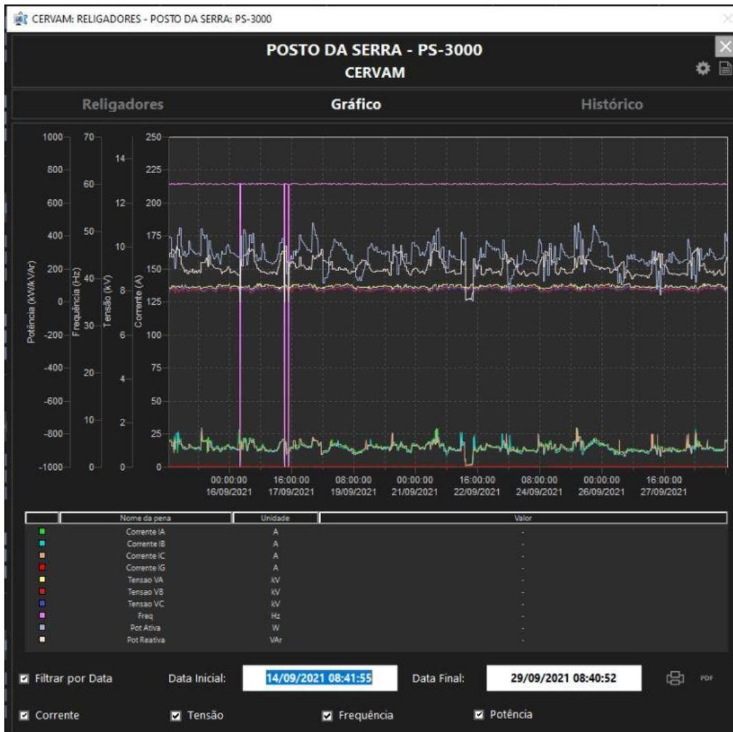
**Figura 3. Amostragem gráfica das correntes, tensões, potências e frequências junto a um religador**
