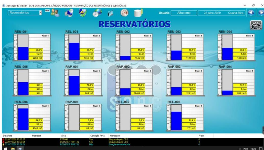
Figura 7. Controle do nível de água nos reservatórios
