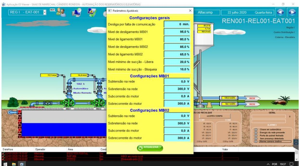
Figura 5. Tela de ajuste das configurações das motobombas
