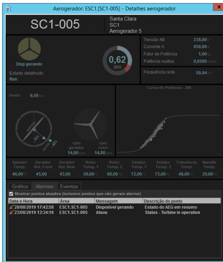
Figura 4. Tela de controle de um aerogerador do Complexo Eólico Santa Clara
