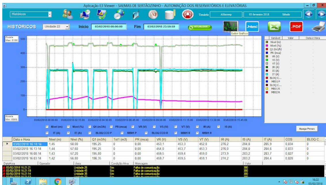
Figura 6. Gráfico de análise das variáveis elétricas das motobombas de uma unidade
