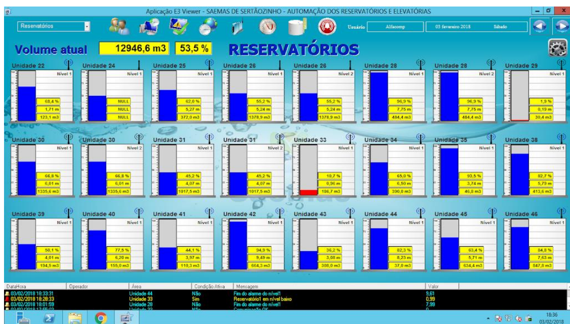
Figura 5. Controle do nível de água presente nos reservatórios
