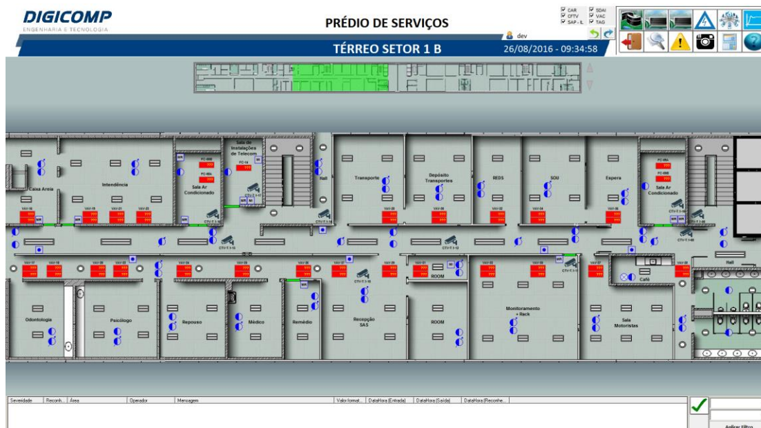
Figura 4. Controle das luminárias, ar condicionados, fancoils, portas, câmeras e sensores do setor 1B do térreo
