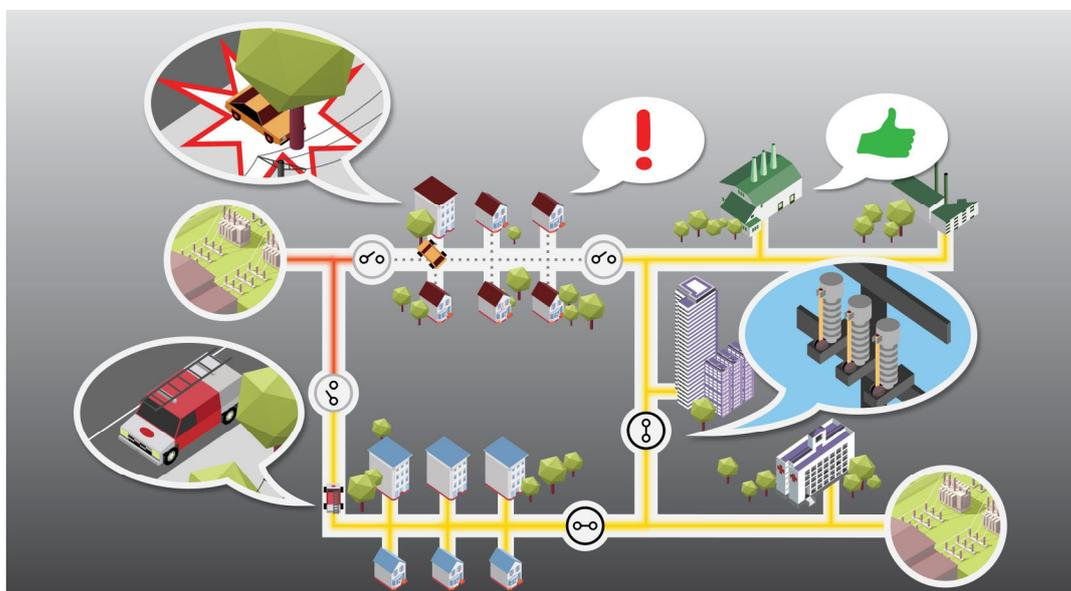
Por meio do modelamento elétrico dinâmico da rede, o módulo de Self-healing é capaz de isolar a falta e restabelecer o maior número de cargas automaticamente.
