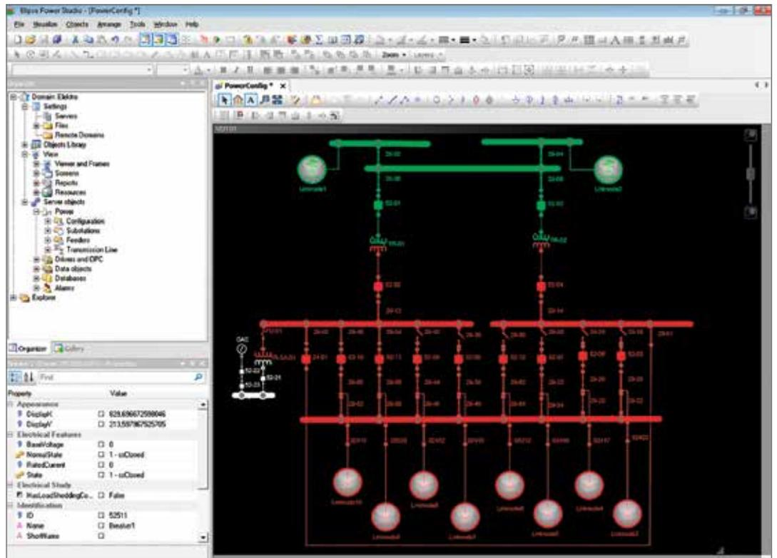
Reúne em uma única plataforma funcionalidades específicas para o desenvolvimento de aplicações para automação de subestações, proporcionando operação local e acesso remoto ao centro de controle, funcionando como um gateway de comunicação.
