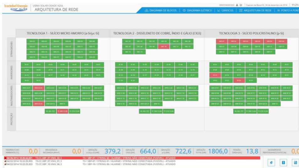
Figura 2. Arquitetura da rede de automação da usina
