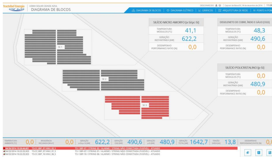
Figura 5. Tela exibindo os três módulos de placas FV, assim como a energia e temperatura assinaladas junto a cada um deles
