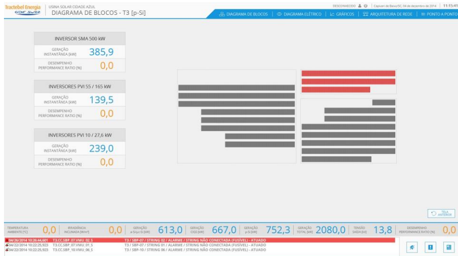
Figura 6. Tela exibindo a energia gerada pela relação das placas de silício policristalino com três diferentes inversores de 10, 165 e 500 kW de potência
