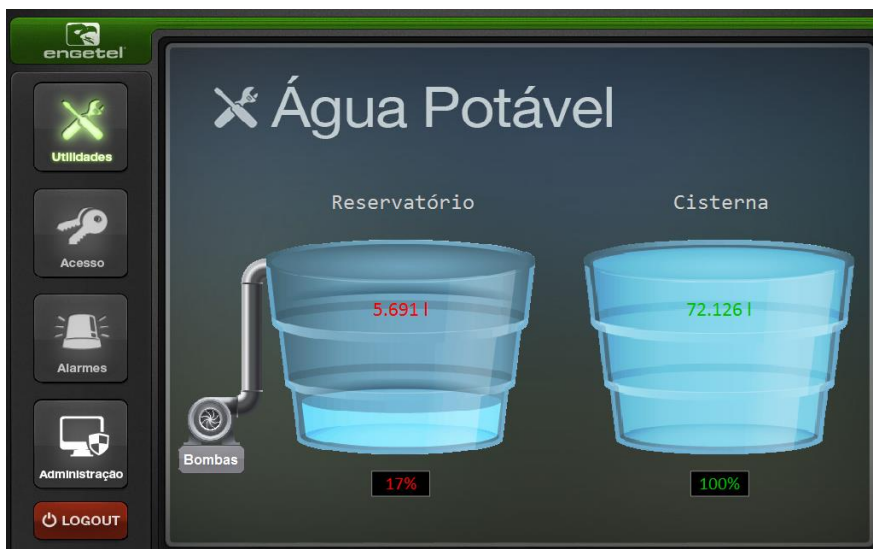
Figura 5. Controle dos níveis da água depositada no reservatório e na cisterna de re-uso
