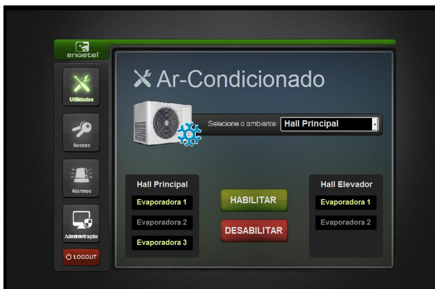
Figura 6. Controle do ar condicionado localizado no hall principal do prédio
