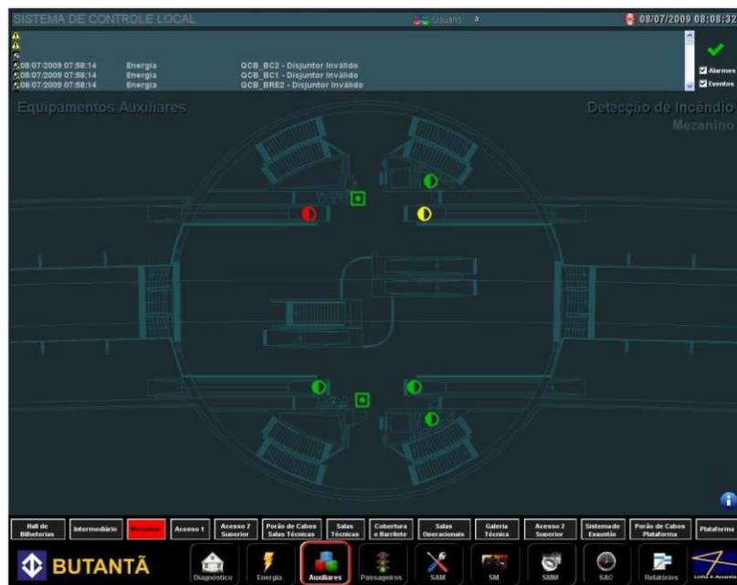
Figura 9. Detecção de incêndio no mezanino com alarme (seta vermelha) e falha (seta amarela)
