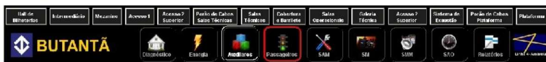
Figura 3. Barra inferior da tela principal do sistema, contendo os ícones e teclas com sistema detector de incêndio
