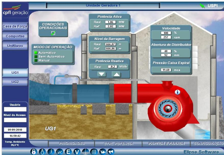
Figura 6. Tela exibindo o percentual de abertura das palhetas do distribuidor
