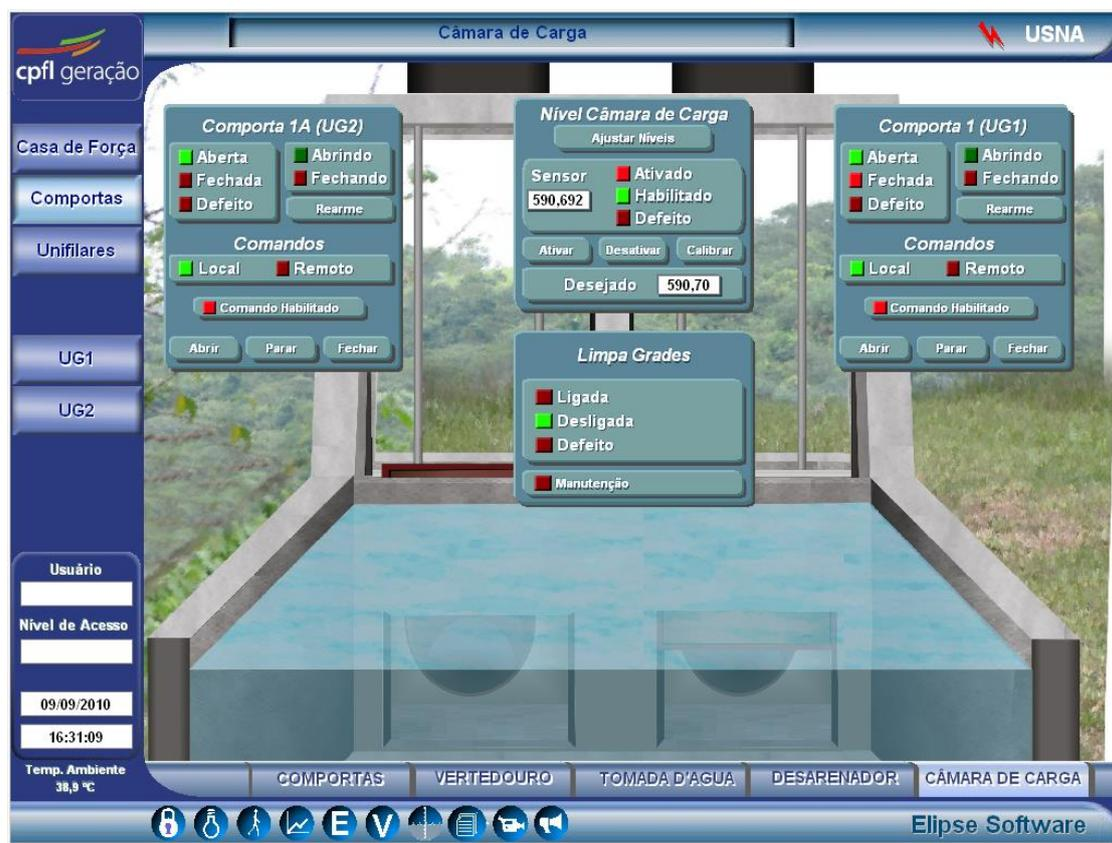
Figura 4. Tela de controle da câmara de carga da PCH
