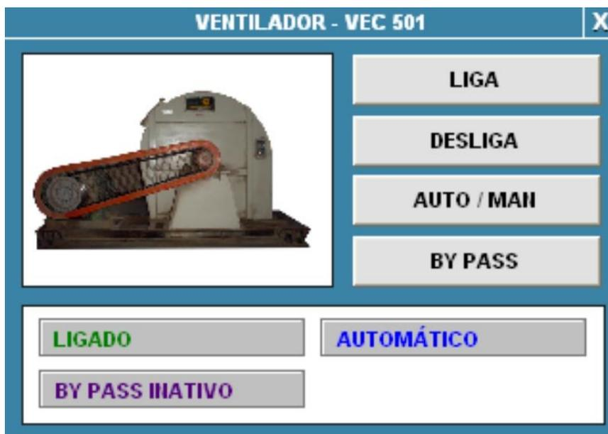
Figura 2. Tela de comando sobre um dos ventiladores
