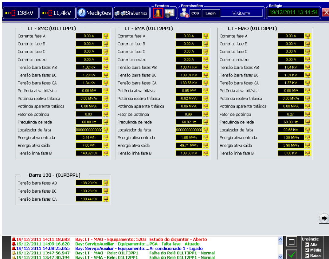
Figura 6. Tela exibindo algumas das medições assinaladas junto à subestação
