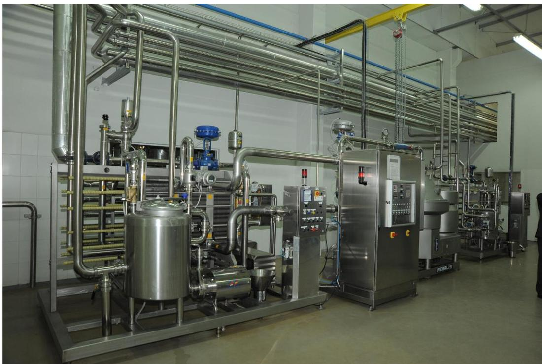
Figura 2. Imagem interna da fábrica mostrando o pasteurizador (mais à esquerda) e a desnatadeira por centrifugação (à direita)
