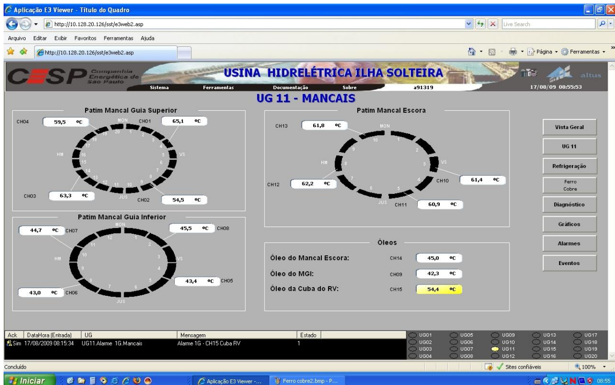
Figura 6. Tela monitorando as temperaturas dos Mancais
