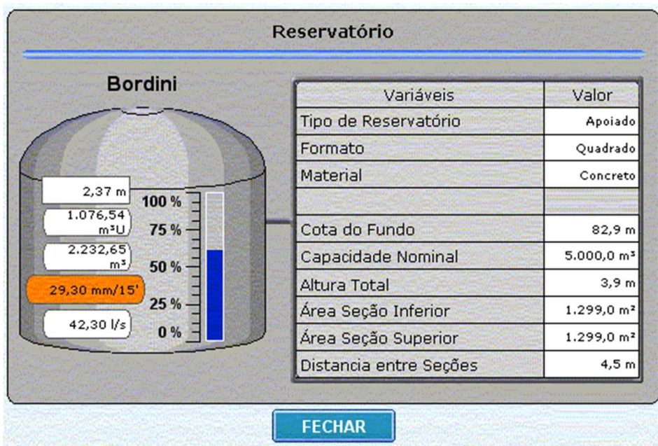
Figura 3. Tela de supervisão de um reservatório de água tratada
