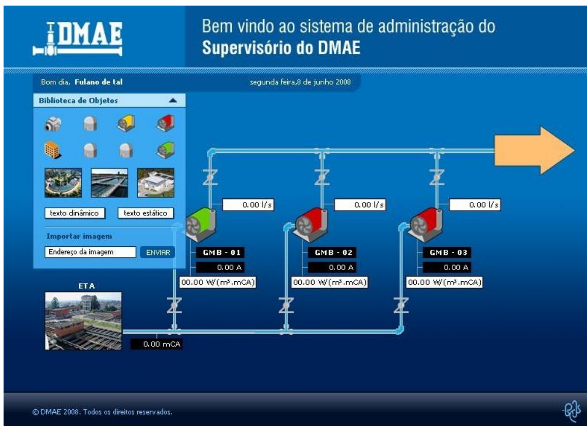
Figura 4. Tela de supervisão de uma estação de bombeamento de água tratada no ambiente for web
